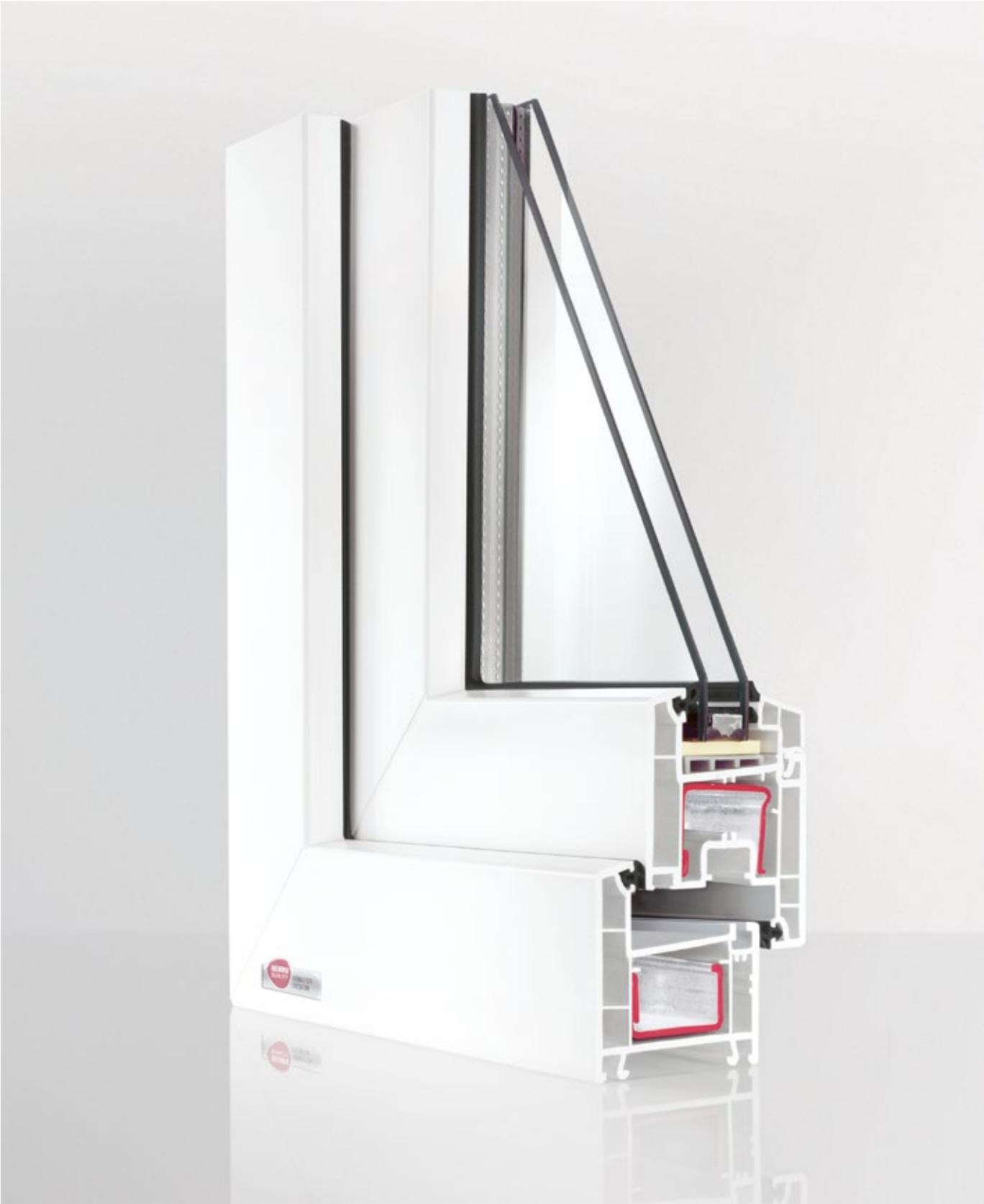
El sistema Euro-Design 60 es un sistema que permite realizar paños fijos o de apertura con cierre de doble contacto. Presenta máximo rendimiento a nivel de aislamiento térmico y es ideal para la utilización en proyectos donde el nivel de ruido es un factor crítico. Gracias a su cierre perimetral, con juntas doble punto, el aislamiento acústico puede llegar a alcanzar 45 STC\* (45 dB).
